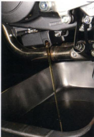
L'impianto di lubrificazione a carter secco di questo bicilindrico prevede una pompa di recupero ed una di mandata. Questo è il foro di svuotamento di parte del circuito; esso è sigillato da una vite a testa esagonale da 17 mm.
