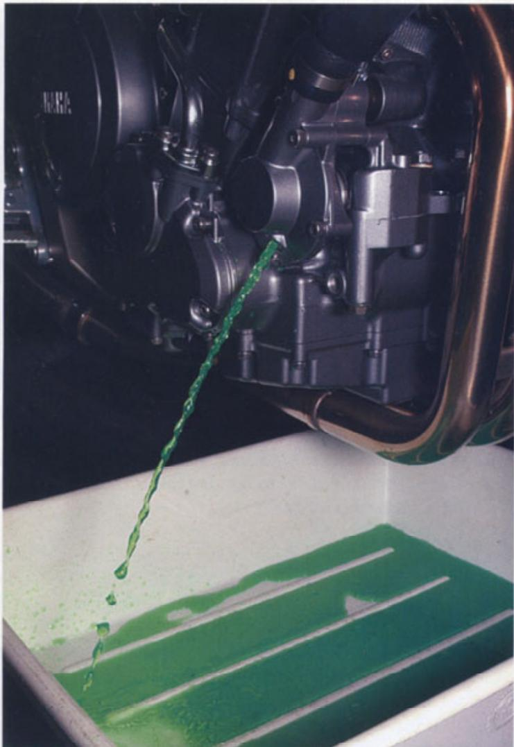
La vite di spurgo dell'impianto di raffreddamento si trova sul lato inferiore alla pompa, sul lato destro della moto.
