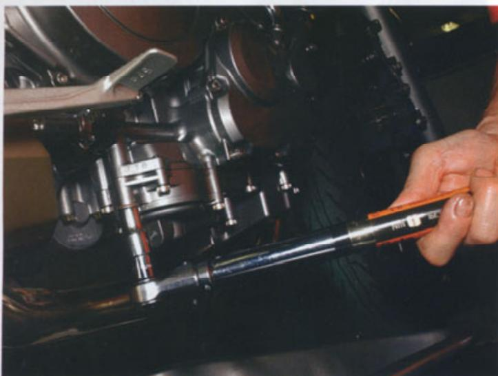
La chiave dinamometrica: uno strumento insostituibile in officina. Nell'immagine la fase di chiusura di una delle viti di svuotamento impianto olio.
