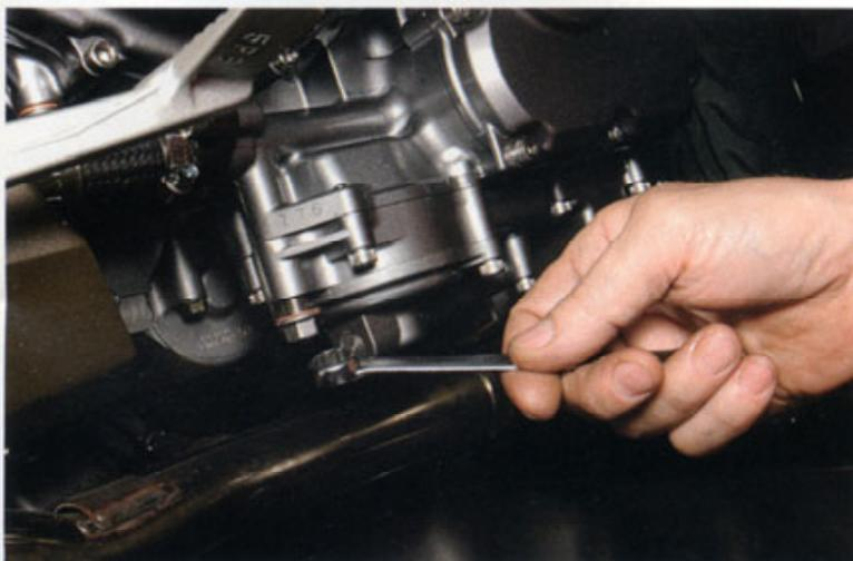
Ecco dove si trova il secondo foro di svuotamento dell'impianto. La vite è orientata verticalmente e alloggiata in prossimità del carter che contiene il filtro.
