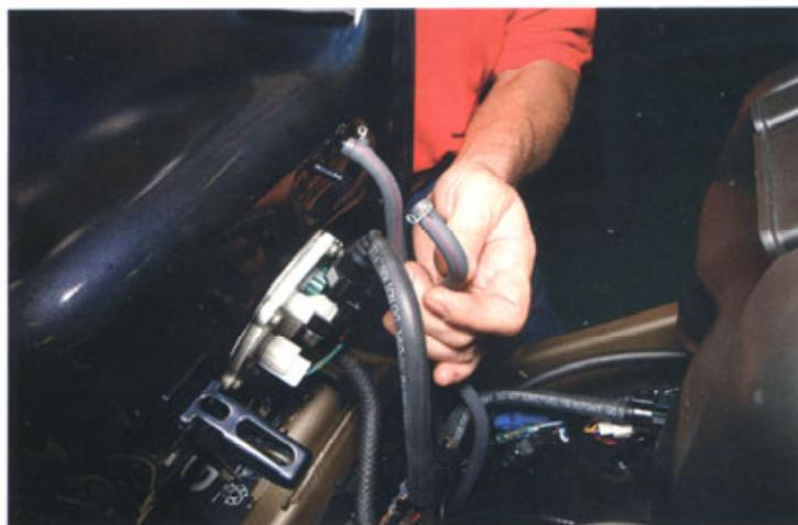
Per poter asportare il serbatoio è necessario staccare numerose tubazioni. Le principali, quelle di mandata e ritorno del carburante, si distinguono per una grande sezione e per la presenza di valvole di non ritorno. Vi sono poi due contatti elettrici ed alcuni tubi di sfiato.
