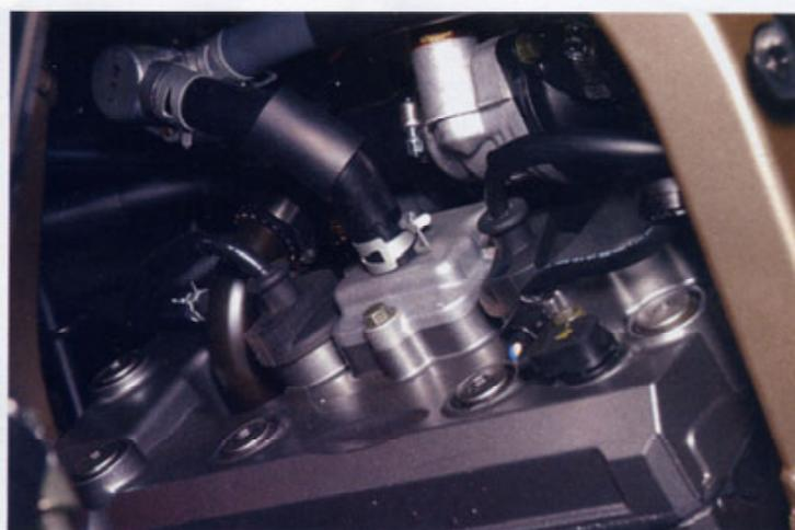
Così si presenta il coperchio punterie una volta asportato il radiatore. Si noti, in secondo piano, il termostato.
