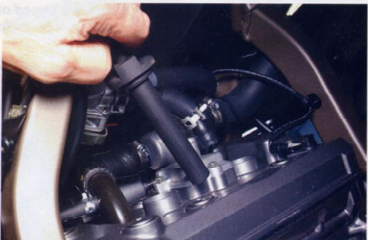
Si comincia con l'estrazione delle pipette e quindi si prosegue con la sostituzione delle candele.
