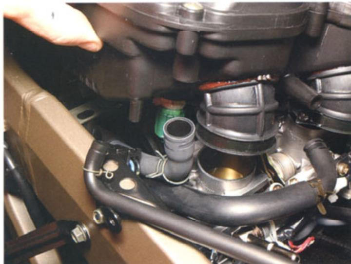
Nell'immagine, in primo piano i tubi da staccare per poter asportare l'airbox. In basso i corpi farfallati.
