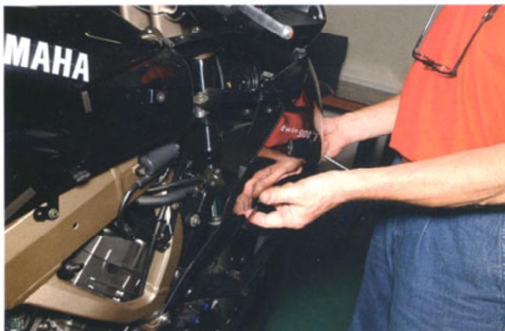
Una fase dello smontaggio di una delle semicarene anteriori. Occorre porre molta attenzione in questa operazione vista la quantità di viti nascoste.
