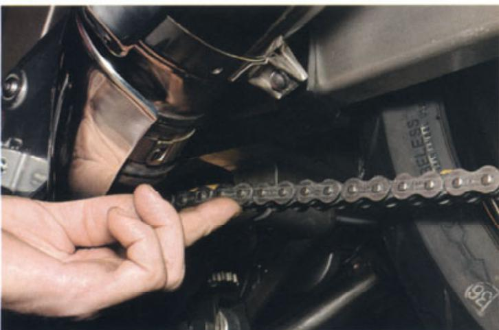
Da non dimenticare il controllo periodico della tensione della catena.
