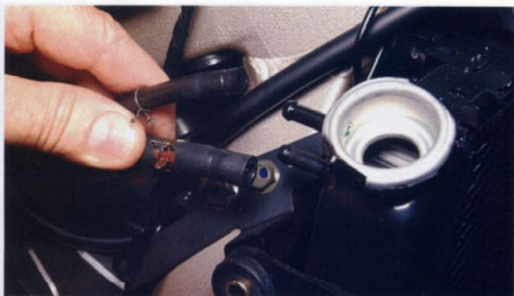
Prima di smontare il radiatore, in modo da avere libero accesso alla testata, è necessario staccare i due tubicini di spurgo aria e la connessione elettrica del ventilatore.
