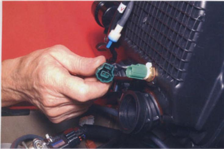
Anche la parte inferiore dell'airbox presenta alcuni piccoli tubi da staccare. Nell'immagine il contatto elettrico che alimenta il sensore temperatura in aspirazione.
