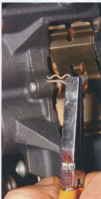
La sostituzione delle pastiglie freno anteriori è un'operazione molto semplice. Nell'immagine l'estrazione della molla a flessione, effettuata con l'ausilio di una pinzetta.
