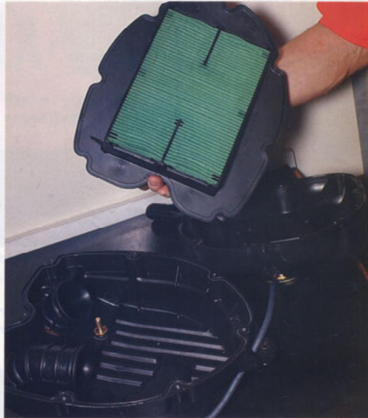
Aperto l'airbox, sigillato da otto viti sul piano orizzontale, la sostituzione del filtro è elementare.
